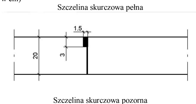
Rys. 1.1. Przykłady konstrukcji szczelin w podbudowie z betonu cementowego (wymiar w cm)
